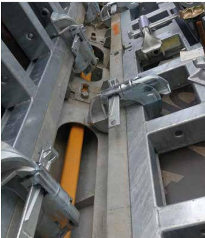
Unión de paneles BATEK a la ESCUADRA DESENCOFRADO MAX
