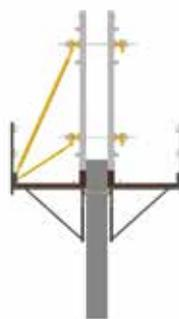
*Encofrado de muro curvo con trepado por ambas caras*
